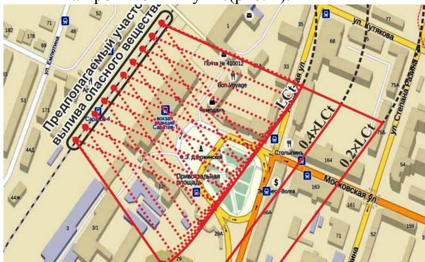
Рисунок 2 – Модель расчета зон токсического поражения при потоке локальных выбросов из движущегося состава
